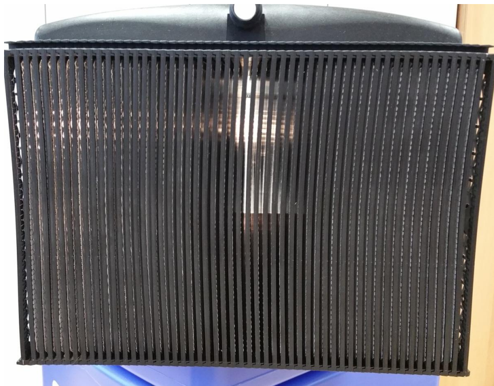
Figure 18: module de membrane – voir à travers les fentes entre les plaques de membrane
